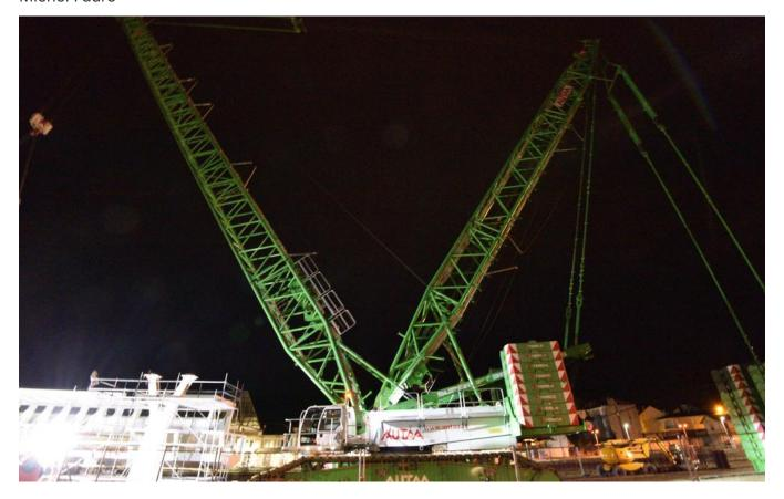
Le transport de la grue à flèche en treillis Autaa, lourde de 650 tonnes, a nécessité 40 semiremorques. Le bras qui a soulevé la grue, l'autre servant de balancier, mesure 66 mètres. Il faut une semaine pour tout démonter, autant pour remonter.
