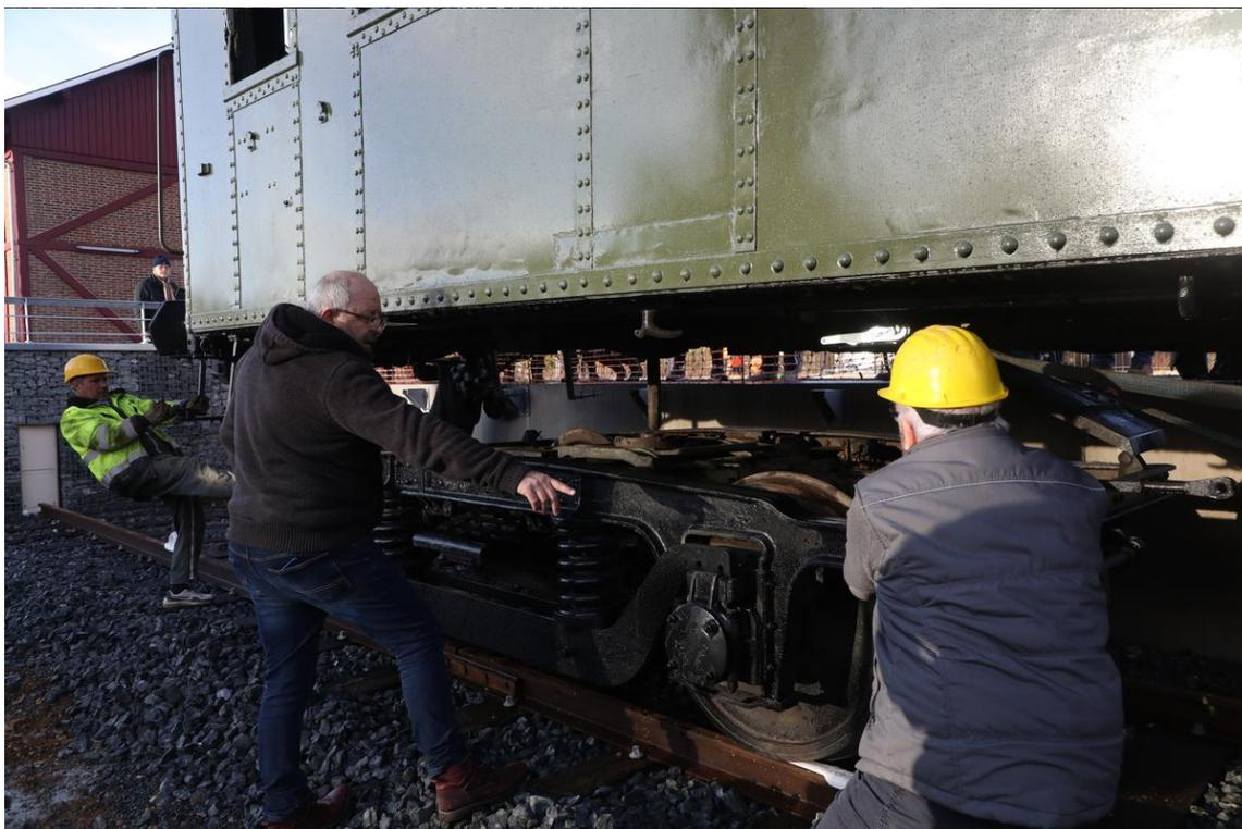
📷 *Il a fallu caler la caisse sur ses bogies, avec ses roues posées sur des rails.*
